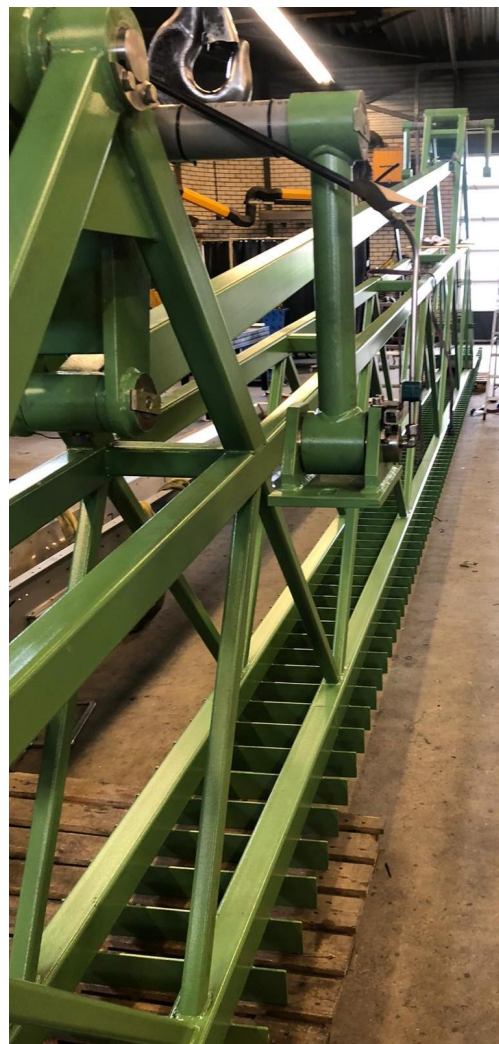
Foto boven: Nieuw frame vervaardigd voor de zandwasser. Lengte 16 meter.
